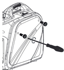
Figure 4-3. Retirer le capot latéral
