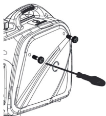
Figure 2-6. Retirer le capot latéral
