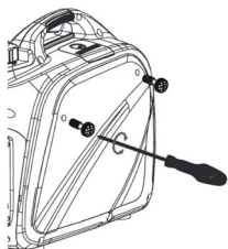
Figura 2-6. Retire la cubierta lateral
