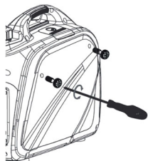
Figura 4-3. Retire la cubierta lateral
